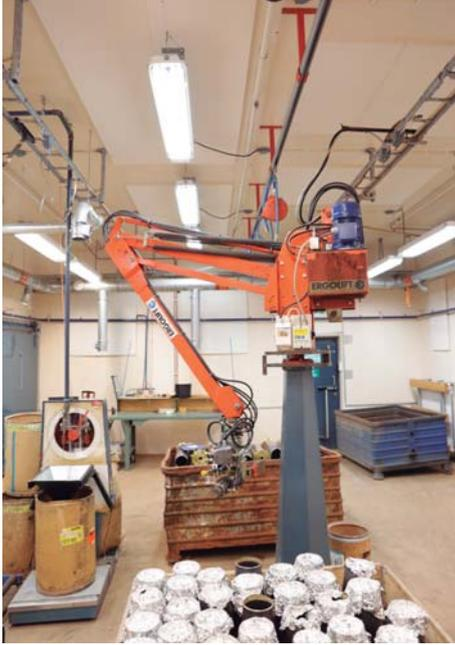
Un dispositivo articulado operado a distancia en una planta de tratamiento (foto NAMMO).
